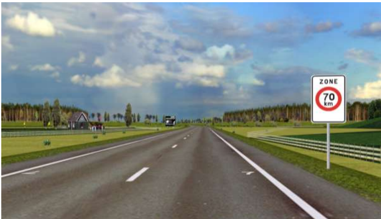
Figuur 3. De snelheidsovergang door middel van een zonebord in de 90-70 km/u in de CIJFERS-route.
