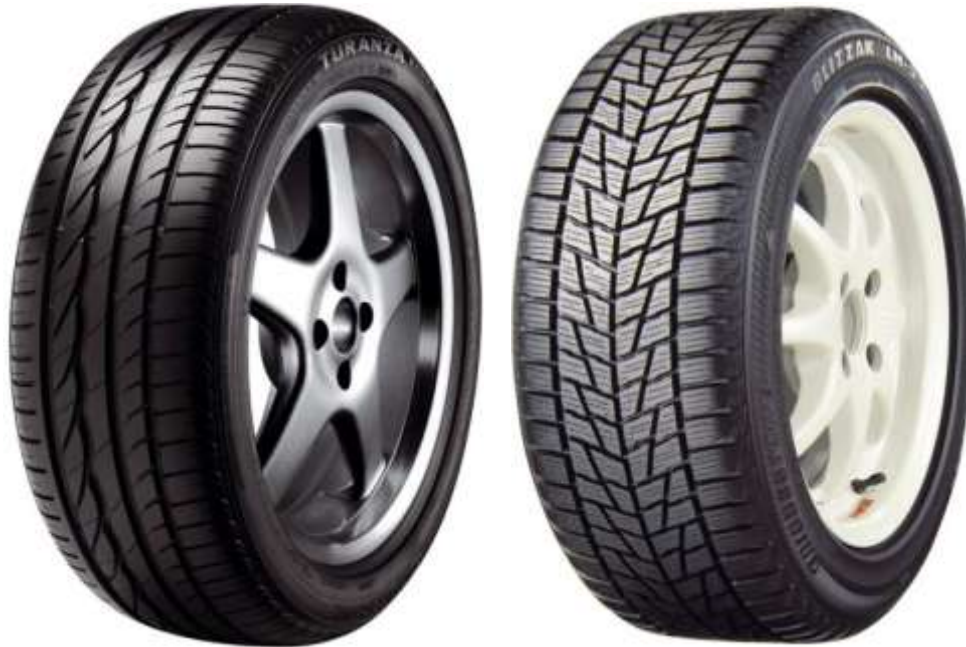
Foto 2: Gewone band (links) zonder en winterband (rechts) met gelamelleerde profielblokken (© Bridgestone)
