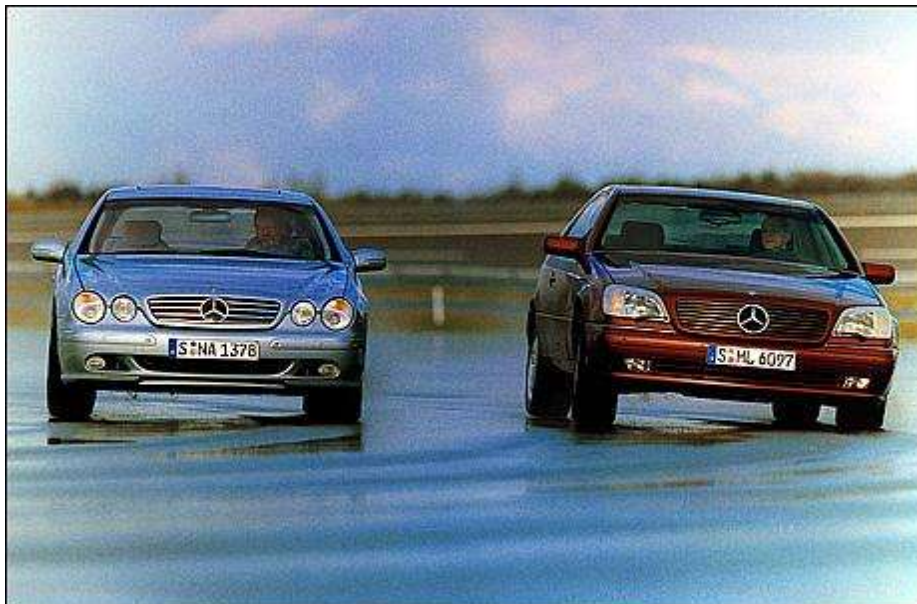
Foto 3: Bochtgedrag van een voertuig met actieve ophanging (links) en een voertuig zonder actieve ophanging (rechts) (© DaimlerChrysler)
