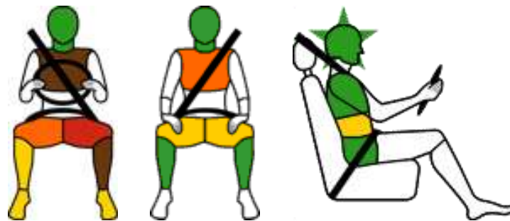
Figuur 6: Grafische voorstelling van een mogelijk letselrisico voor (v.l.n.r.): frontale impact voor bestuurder, frontale impact voor passagier en zijdelingse aanrijding gecombineerd met paaltest voor bestuurder (EuroNCAP, 2005)
