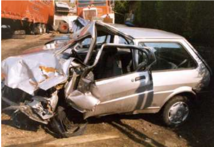
Figuur 13: Resultaten van frontale impact op een Rover 100: boven bij een EuroNCAP-crashtest (EuroNCAP, 2005), onder bij een verkeersongeval (Fails & Minton, 2001)
