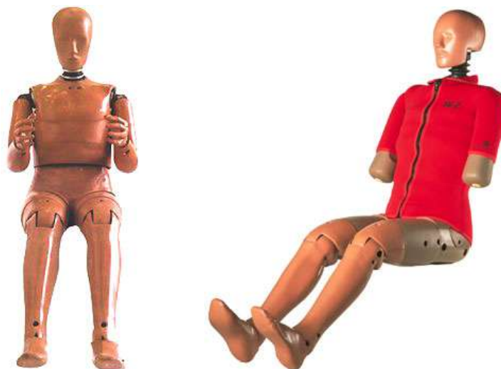
Figuur 5: HYBRID III- (l) en EUROSID II-dummy (r) gebruikt voor respectievelijk de frontale en zijdelingse impacttesten voor de beoordeling van de veiligheid voor volwassen inzittenden (EuroNCAP, 2005)
