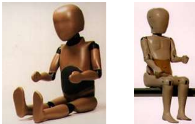
Figuur 8: P-serie dummy's gebruikt voor de beoordeling van de veiligheid van kinderen (FTSS, 2005)
