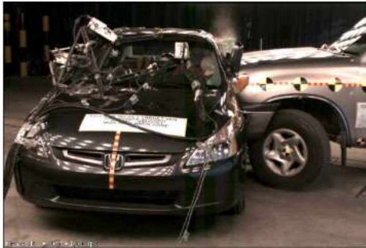
Figuur 1. Zijdelingse crashtest tussen een terreinwagen en een klassieke personenwagen (bron: Summers & Prasad, 2005).
