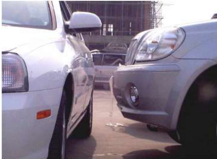
Figuur 13. Illustratie van de incompatibiliteit tussen bumpers van terreinwagens en deuren van klassieke personenwagens bij zijdelingse aanrijdingen (bron: Bae et al., 2001)
