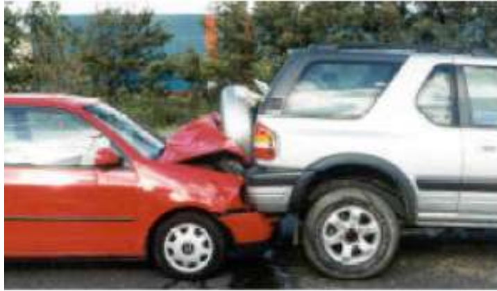
Figuur 3. Achteraanrijding tussen klassieke personenwagen en een terreinwagen (Bron: Margaritis et al., 2005).
