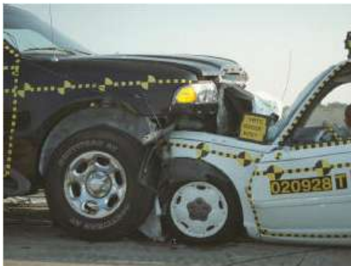
Figuur 2. Frontale crashtest tussen een terreinwagen en een klassieke personenwagen (Bron: Summers et al., 2003).
