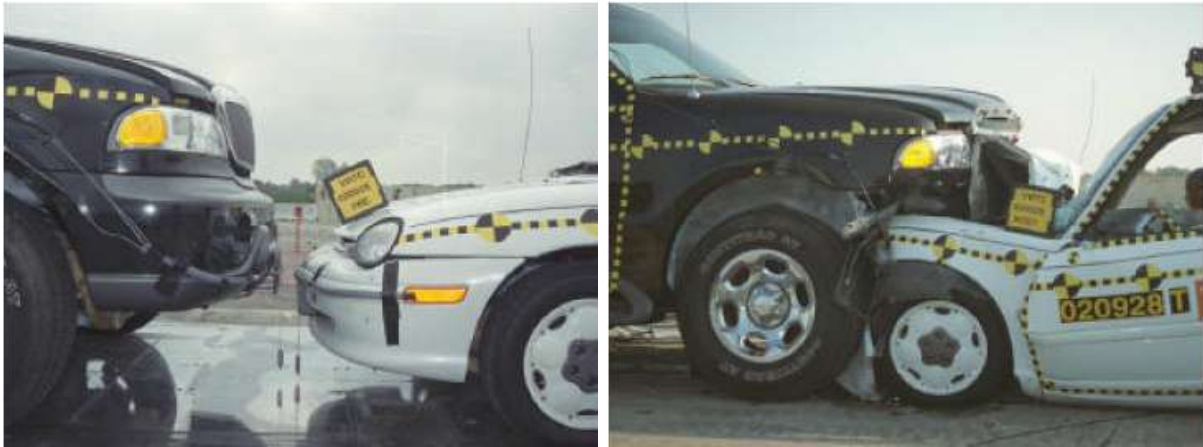
Figuur 14. Crashtest tussen een terreinwagen en een klassieke personenwagen in 1999, waarbij de bumper van de terreinwagen hoger is dan de verstevigende structuur van de personenwagen (L). Bij de crashtest kwam de voorkant van de terreinwagen bovenop de klassieke personenwagen terecht (R) (Summers et al., 2003).
