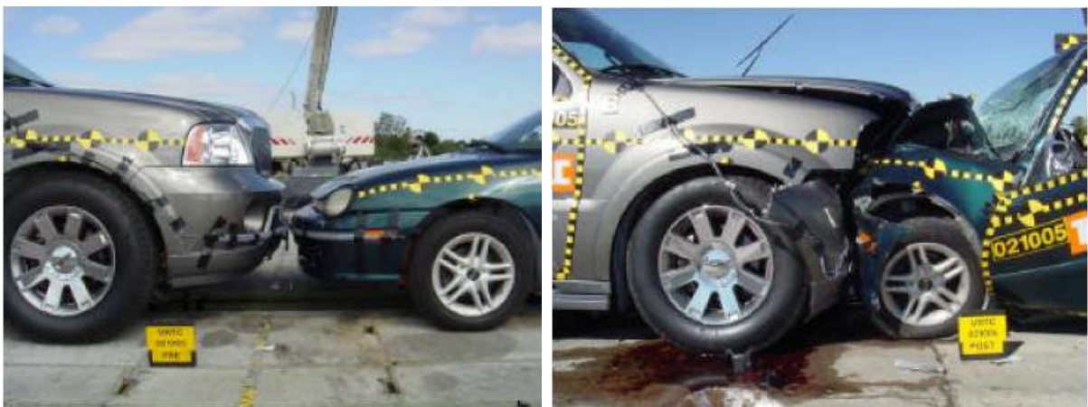
Figuur 15. Crashtest tussen de vernieuwde terreinwagen (modeljaar 2003) en dezelfde klassieke personenwagen in 2003, waarbij de bumper van de terreinwagen verlaagd is tot op de hoogte van de verstevigende structuur van de personenwagen (L). Bij de crashtest interageerde de verstevigde structuren van beide wagens beter met elkaar t.o.v. de crashtest in 1999 (R), maar werd er meer energie geabsorbeerd door de klassieke personenwagen (Summers et al., 2003).
